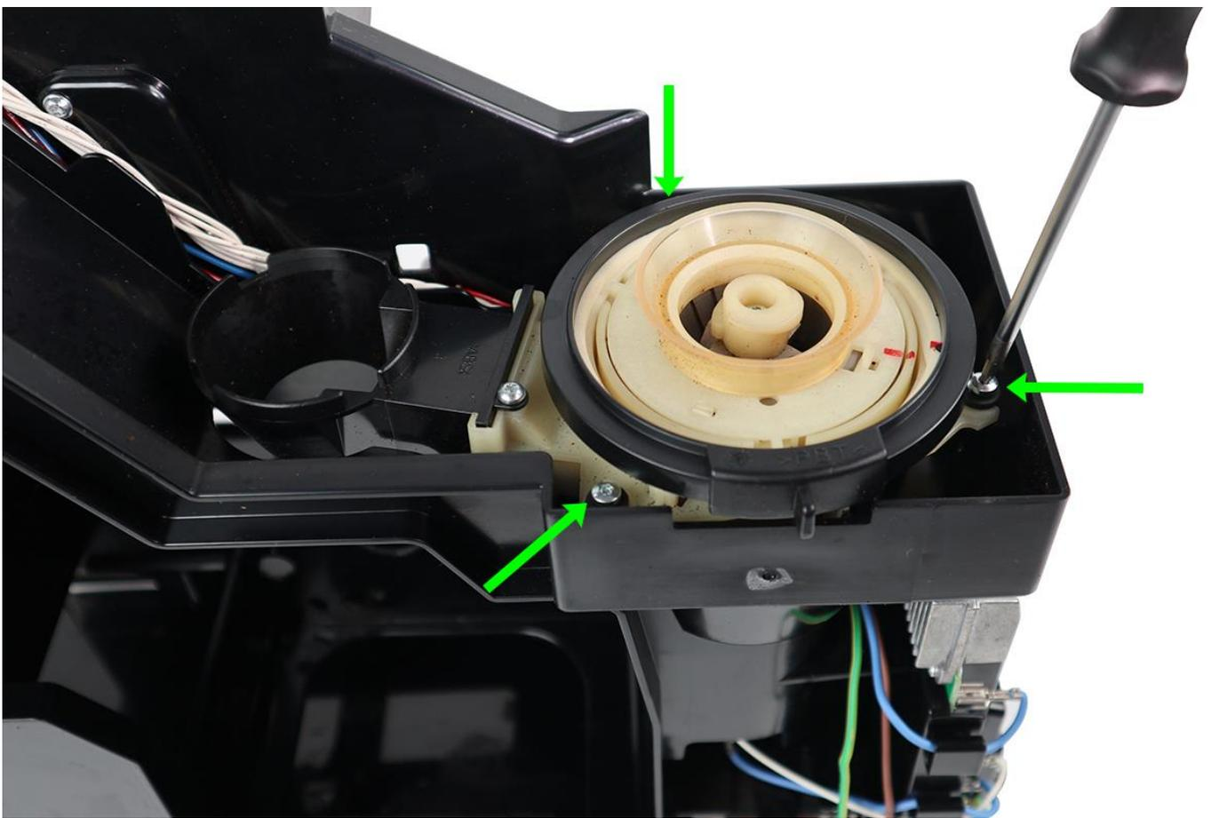
Entfernen Sie zuerst die 3 Schrauben mit denen das Mahlwerk im Gehäuse befestigt ist.
