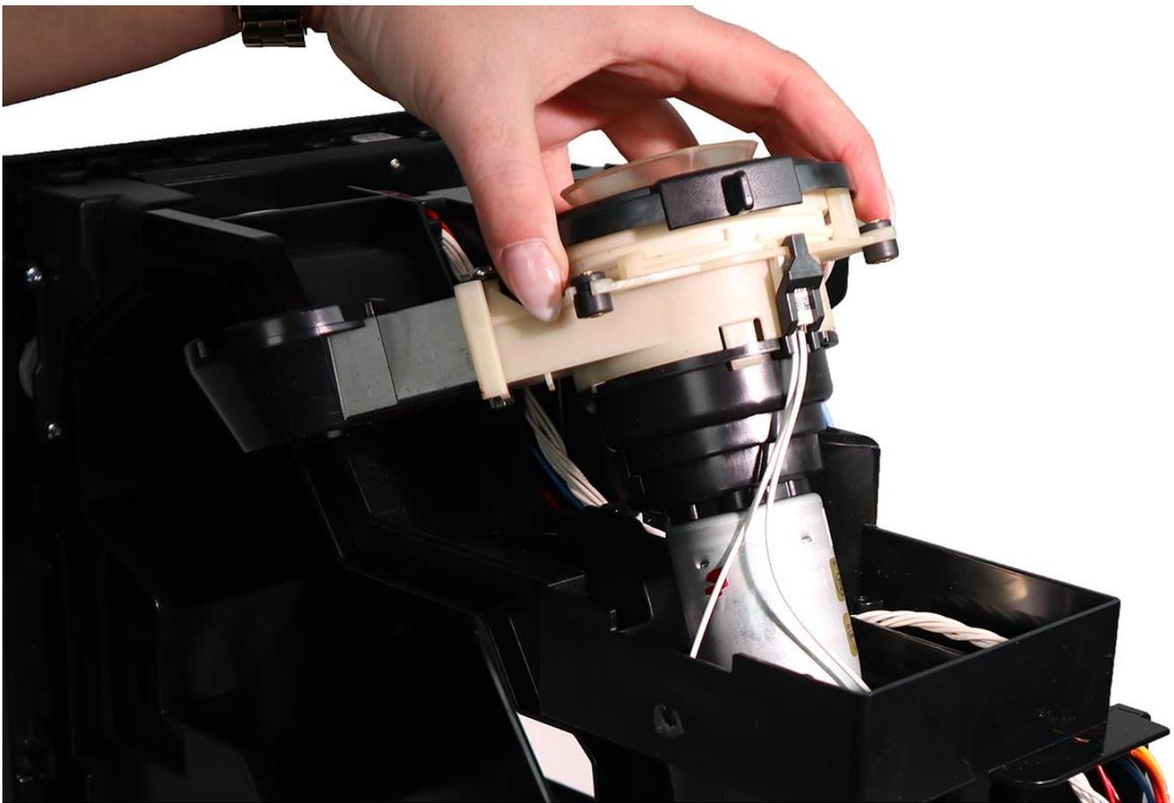
Jetzt können Sie das Mahlwerk komplett herausnehmen. Fertig – Der Zusammenbau erfolgt in umgekehrter Reihenfolge.
