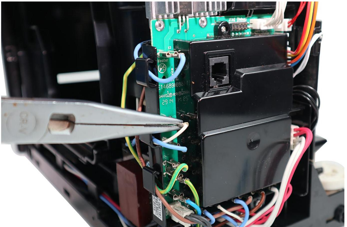
Ziehen Sie danach den Stecker des Mahlwerk-Anschlusskabels von der Platine ab.
